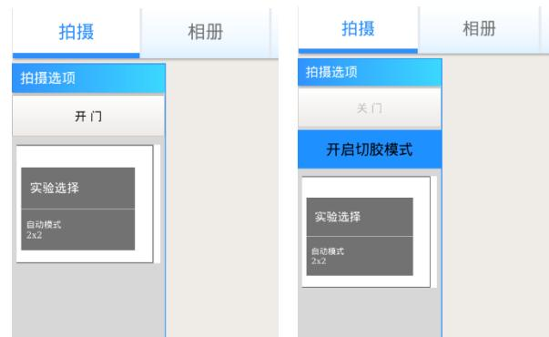
②实验选择：点击“实验选择”，根据自己的样品类型，点击选择“Nucleotide acid Gels”、“protein Gels”或者“Blots”选择样品类型，在对应的样品类型中点击选择样品的“染色方式”。在“Users”界面下用户可以自定义滤光片和光源；
